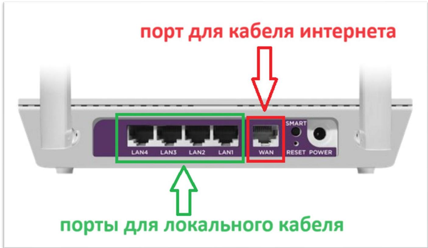
Далее настроить роутер можно двумя способами, подключившись к нему с любого устройства по WiFi или подключив его локальным кабелем, идущим в комплекте к роутеру.
